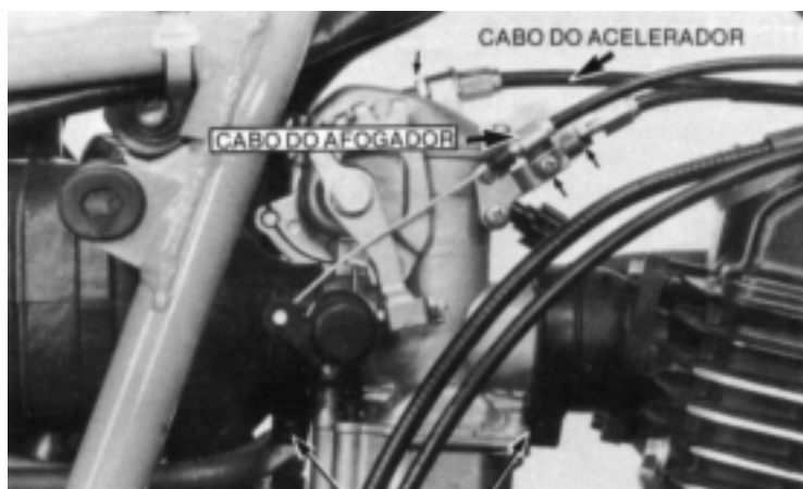
PRESILHAS DE FIXAÇÃO DO CARBURADOR
